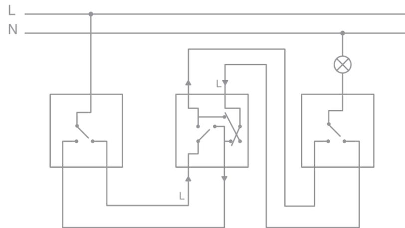
Схема подключения с трех мест с помощью двух одноклавишных перекрестных выключателей
